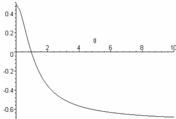
Рис. 4. Зависимость средней глобальной степени линейной поляризации излучения заряда от интенсивности внешней электромагнитной волны  $g$ . Заряд движется в поле линейно поляризованной волны (при  $\psi = \frac{\pi}{2}$  в плоскости  $zy$ , при  $\psi = 0$  в плоскости  $zx$ ). Вектор поляризации  $\vec{j}$  направлен вдоль оси  $z$ .
