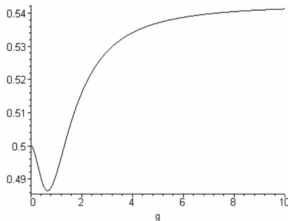
Рис. 5. Зависимость средней глобальной степени линейной поляризации излучения заряда от интенсивности внешней электромагнитной волны. Заряд движется в поле эллиптически поляризованной волны  $\psi = \frac{\pi}{3}$  в плоскости  $xy$ . Вектор поляризации  $\vec{j}$  направлен вдоль оси  $z$ .
